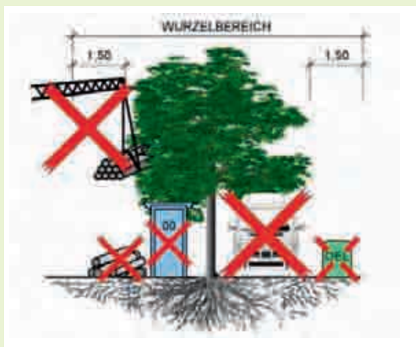
Schutz von Bäumen bei vorübergehender Grundwasserabsenkung
